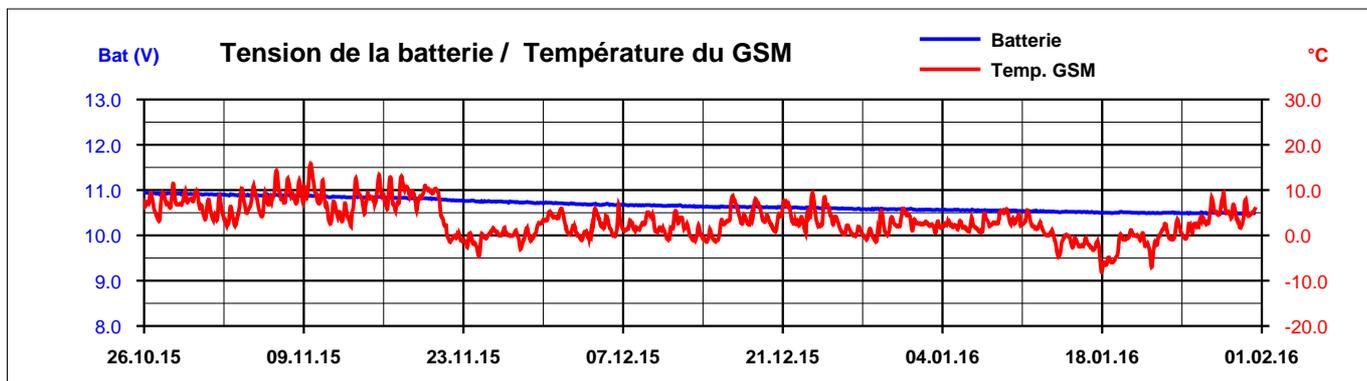
Lors de chaque mesure, la tension des batteries est transmise. Il s'agit de cellules 8-D.
