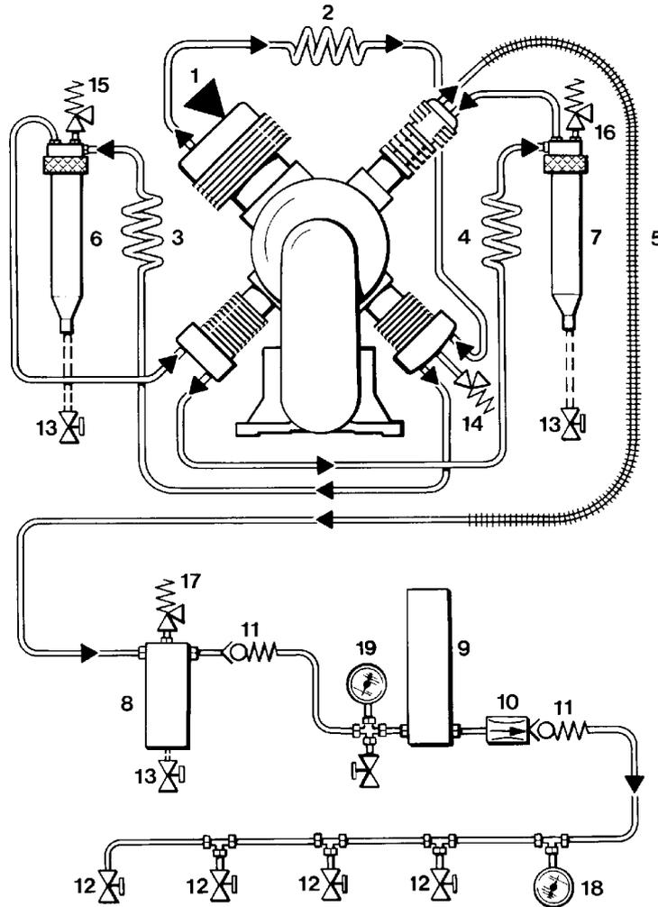
Abb. 6 Rohrleitungsschema K14, K15, K150, K180
