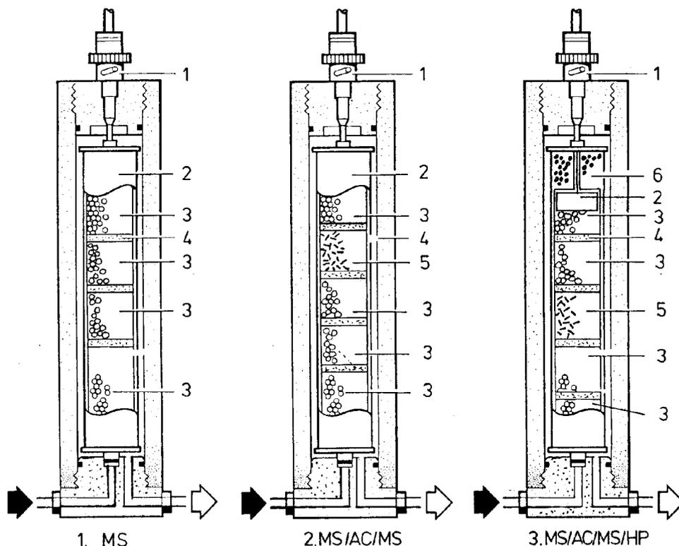
Abb. 30 Filterpatronenaufbau
