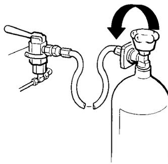
Abb. 19 Anschließen der Druckluftflaschen
