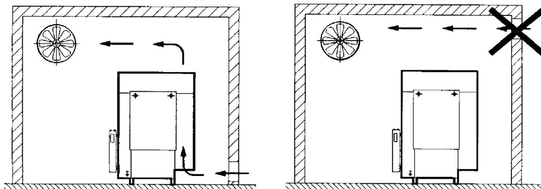
Richtig: die Luft strömt entlang einer gedachten Strömungslinie durch den Kompressor
