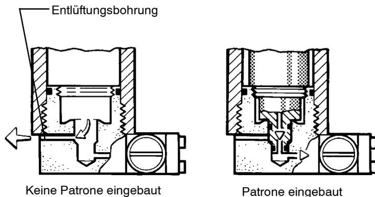
Abb. 27 Entlüftungsbohrung
