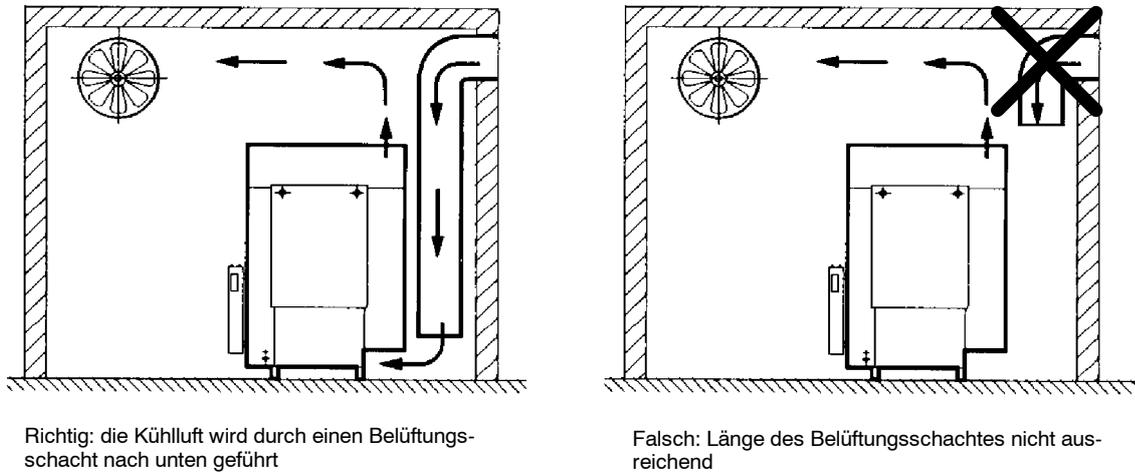
Abb. 17 Aufstellung mit künstlicher Belüftung, Beispiel 2
