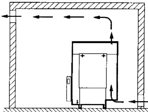
Richtig: Lufteinlaß niedrig, Kühlluft strömt durch die Anlage
