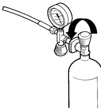
Abb. 20 Anschließen der Druckluftflaschen
