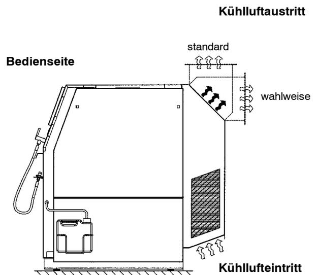
Abb. 10 Kühlluftführung
