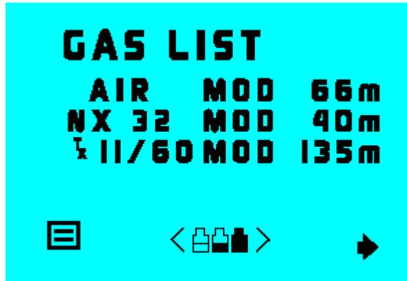
Ein Druck auf die linke Kontrolltaste (☰) bringt Sie wieder zum Menü „Options“ zurück. Ein Druck auf die rechte Kontrolltaste < → > zeigt die nächste Seite mit Gasen an. Ein kurzer Druck auf beide Tasten < ☰ > wechselt zum Modus Profile „Profiles“.
