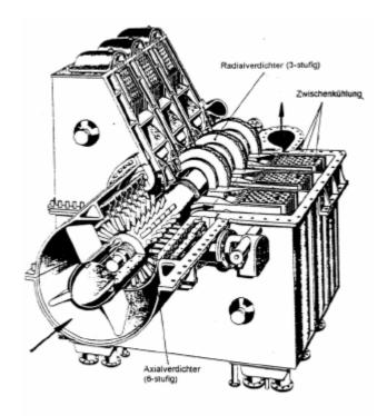
Kombinierter Axial- und Radialturboverdichter
