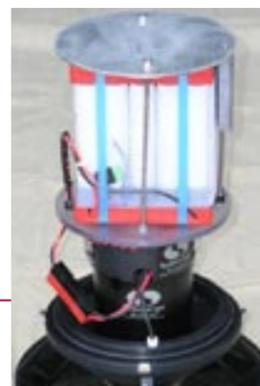
Aufgeräumt: Akku und Motorblock des Submerge UV
