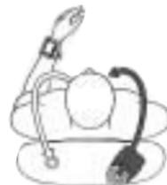
Ausrichtung bei rechtsseitigem Einatemschlauch und Linksträger
