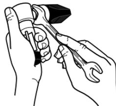
Drucksender mit einem 19er Gabelschlüssel festziehen.
