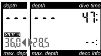
Nach dem Erreichen der Oberfläche geht der Aladin® Air Z O<sub>2</sub> automatisch für fünf Minuten in den Wait-Modus. Diese Zeit ist nötig, um den Tauchgangabschluss zu erkennen. Die Verzögerung erlaubt ein kurzzeitiges Auftauchen zur Orientierung oder für einen Flaschenwechsel.
