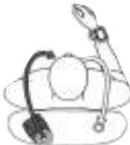
Ausrichtung bei linksseitigem Einatemschlauch und Rechtsträger
