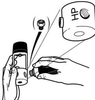
Sender am HP-Ausgang montieren. Wenn die Gewinde nicht übereinstimmen, erhalten Sie im Fachhandel einen passenden Adapter.
