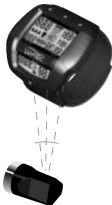
1. Jeder Sender sendet mit einer ihm zugeteilten Adresse. Diese Adresse wird dem Tauchcomputer beim Paarungsvorgang mitgeteilt. Es existieren im Moment über 60'000 verschiedene Adressen. Damit ist gewährleistet, dass nicht zwei Sender auf dem gleichen Kanal senden können. Zur Paarung eines Senders und eines Empfängers wird ein Verfahren verwendet, das ebenfalls mehrere Sicherheitsstufen beinhaltet, um eine Falschpaarung zu verhindern.
