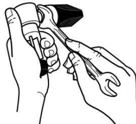
Sender mit einem 19er Gabelschlüssel festziehen.
