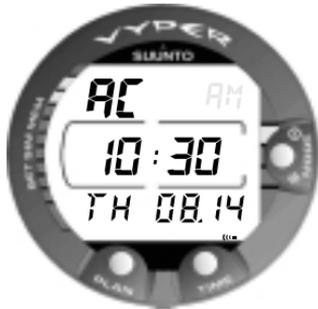
Abb. 2.4 Die Aktivierung der Wasserkontakte wird durch den Text AC dargestellt.
