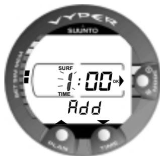
**Abb. 4.20 Gewählter Modus Tauchgangsplanungssimulation.** Fügen Sie eine Oberflächenpause ein, indem Sie die Kontakte TIME und PLAN drücken. Hinweis ! Diese Anzeige wird nur für Wiederholungstauchgänge darstellt.
