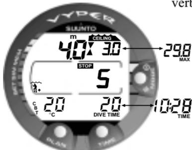
**Abb. 3.14 Ein vorgegebener Sicherheitsstopp.** Sie werden aufgefordert, einen vorgegebenen Sicherheitsstopp in einem Tiefenbereich zwischen 6 m und 3 m durchzuführen. Durch drücken von TIME erscheint die alternative Anzeige.
