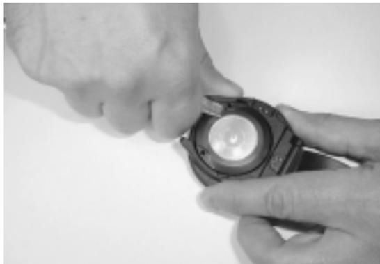
**Abb. 5.2. Öffnen des Sicherheitsringes.**
