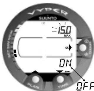
Abb. 4.30 Einstellen des Tiefenalarms. Drücken Sie PLAN und TIME, um den Alarm ein-/auszuschalten und die maximale Tiefe einzustellen.
