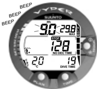
**Abb. 3.13 Aufstiegsanzeige.** Blinkende Tiefenanzeige, SLOW und 4 Segmente werden angezeigt: Aufstiegs-geschwindigkeit ist über 10 m/min. Dies ist ein Hinweis, die Geschwindigkeit zu reduzieren ! Das STOP-Symbol erscheint, weil Sie einen vorgegebenen Sicherheitsstopp in einer Tiefe von 6 m durchführen.
