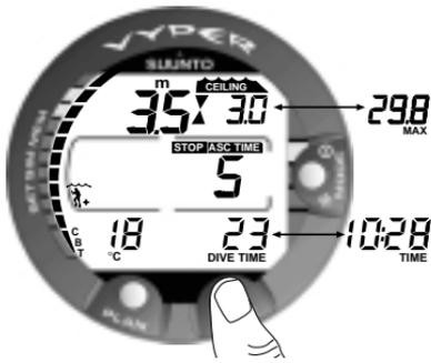
**Abb. 3.18 Dekompressions-Tauchgang in der Deko-Stufe.**
