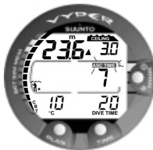
**Abb. 3.16 Dekompressions-Tauchgang unterhalb der Deko-Grenze.** Der Pfeil nach oben und die blinkende Anzeige ASC TIME weisen Sie darauf hin, aufzusteigen. Die minimale Aufstiegszeit, beinhaltend den Sicherheitsstop, beträgt 7 Minuten. Die Deko-Stufe ist bei 3 m.
