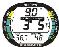
Abb. 3.18. Dekompressionstauchgang oberhalb der Dekompressionsgrenze. Der aufwärts gerichtete Pfeil ist verschwunden und ASC TIME blinkt nicht mehr, d.h. Sie befinden sich im Dekompressionsbereich.
