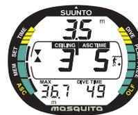
Abb. 3.19. Dekompressions-tauchgang innerhalb der Dekompressionszone. Zwei gegeneinander gerichtete Pfeile ("Sand-uhr") erscheinen. Sie befinden sich im optimalen Deko-Bereich in 3,5m [11ft] Tiefe und Ihre minimale Aufstiegszeit beträgt 5 Minuten.
