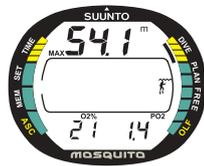
Abb. 3.21. Nitrox-Anzeige. Die maximale Tiefe basierend auf den Einstellungen O<sub>2</sub>% (21%) und PO<sub>2</sub> (1,4 bar) beträgt 54,1 m [177ft].
