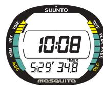
Abb. 2.7. Die Stopuhr zeigt Stunden, Minuten und Sekunden.
