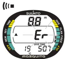
Abb. 3.32. Anzeige nach Überschreitung des 5 Min. Freitauchlimits. Blinkendes Er und aufwärtsgerichteter Pfeil.
