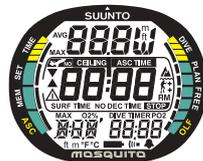
Abb. 3.2. Startdisplay I. Alle Segmente der Anzeige erscheinen.
