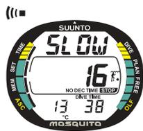
Abb. 3.15. Aufstiegsgeschwindigkeitsanzeige. Blinkendes SLOW und 4 Segmente werden angezeigt, ein akustischer Alarm ertönt: Aufstiegsgeschwindigkeit liegt über 10m /Min. [33ft/min]. Dies ist ein Hinweis, die Geschwindigkeit zu reduzieren. Das STOP- erscheint, weil Sie einen vorgegebenen Sicherheitsstop in einer Tiefe von 6m [20ft] durchführen sollten.
