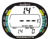
Abb. 3.10. Der Tauchgang hat gerade erst begonnen. Die verfügbare Nullzeit ist größer als 199 Minuten.
