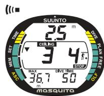
Abb. 3.14. Verletzung des verbindlichen Sicherheitsstops. Der abwärts gerichtete Pfeil und der akustische Alarm weisen Sie darauf hin, auf die geforderte Tiefe abzutauen.
