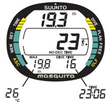
Abb. 3.11. Anzeige während des Tauchgangs. Die aktuelle Tiefe ist 19.3 m [63 ft] und die Nullzeit beträgt im Modus A0/ P1 23 Minuten. Die maximal bei diesem Tauchgang erreichte Tiefe war 19.8m [65 ft], bisherige Tauchzeit ist 16 Minuten. Die alternative Anzeige zeigt Temperatur und aktuelle Uhrzeit.
