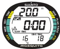
Abb. 3.24. Anzeige im Oberflächenmodus. Sie haben einen 18- minütigen Tauchgang durchgeführt, dessen maximale Tiefe 20,0m [66ft] betrug. Ihre aktuelle Tiefe ist 0,0m [0ft] und die Dauer der Oberflächenpause beträgt 0 Min. Das Flugverbots-Symbol zeigt, dass Sie nicht fliegen sollten und das ACHTUNG-Symbol weist Sie da-rauf hin, dass Sie Ihre Oberflächen-pause wegen des Auftretens von Mikrobläschen verlängern sollten.
