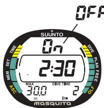
Abb. 4.11. Tauchzeitalarm. Das mittlere Display zeigt eine verbleibende Tauchzeit unter 5 Minuten an.
