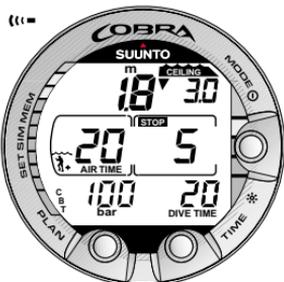
Abb. 3.15. Nicht eingehaltener verbindlicher Sicherheitsstop. Ein ab-
