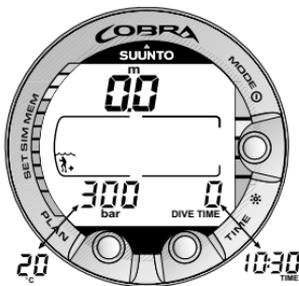
Abb. 3.3. Aktivierung III. Oberflächenmodus: Tiefe und Tauchzeit sind Null, der Tankdruck beträgt 300 bar. Durch Betätigen des TIME Kontakts können Sie die Anzeige von Temperatur und aktueller Uhrzeit aktivieren.
