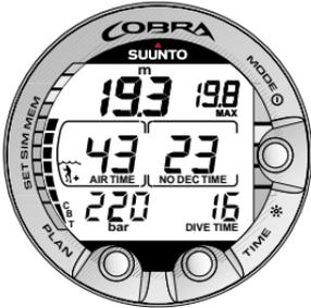
Abb. 3.8. Anzeige während des Tauchgangs. Die aktuelle Tiefe ist 19,3 m und die Nullzeit beträgt im Modus A0/P1 23 Minuten. Die maximal bei diesem Tauchgang erreichte Tiefe war 19,8 m, bisherige Tauchzeit ist 16 Minuten.
