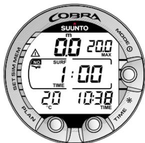
Abb. 3.29. Oberflächenintervall. Dauer der Oberflächenpause. Durch Drücken des TIME-Kontaktes wird die Dauer der Oberflächenpause dargestellt.
