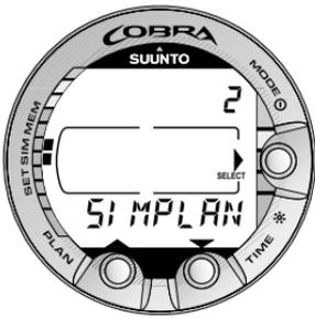
Abb. 4.19. Modus Tauchgangsplanungs-Simulation. [2 SIMPLAN].
