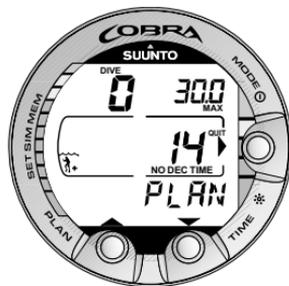
Abb. 3.6. Tauchgangsplanung. Der Text PLAN weist auf den Planungsmodus hin. Die Nullzeit in 30,0 m [100ft] beträgt 14 Min. im Modus A0/P1.
