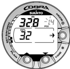
Abb. 4.27. Einstellen des Sauerstoff-Prozentsatzes und Teildrucks. Die zugehörige maximale Tiefe ist 32,8m [107 ft]. Drücken Sie PLAN und TIME, um den Sauerstoff-Prozentsatz zu ändern und den Sauerstoff-Teildruck einzustellen.
