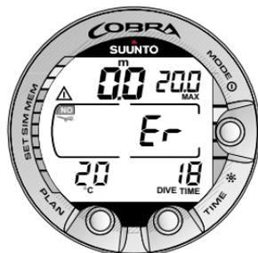
Abb. 3.31. Oberflächenmodus nach Nichtbeachten einer Dekompressionsstufe. Das "Er"-Symbol wird gezeigt, weil Sie eine Dekompressionsstufe länger als 3 Minuten nicht beachtet haben. Sie dürfen innerhalb der nächsten 48 Stunden nicht fliegen.
