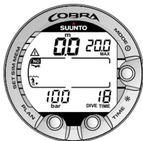
Abb. 3.28. Anzeige im Oberflächenmodus. Sie haben einen 18-minütigen Tauchgang durchgeführt, dessen maximale Tiefe 20,0m [66ft] betrug. Ihre aktuelle Tiefe ist 0,0m [0ft]. Das Flugverbots-Symbol zeigt, dass Sie nicht fliegen sollten und das ACHTUNG-Symbol weist Sie darauf hin, dass Sie Ihre Oberflächenpause wegen des Auftretens von Mikrobläschen verlängern sollten.
