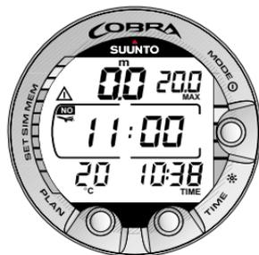
Abb. 3.30. Oberflächenintervall, Flugwarnung. Ein zweimaliges Drücken des TIME-Kontaktes zeigt die Zeit bis zum Ablauf der Flugverbotszeit, symbolisiert durch ein Flugzeug, an.
