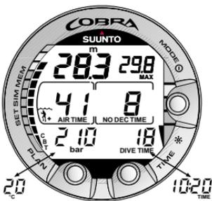
Abb. 3.9. Anzeige während des Tauchgangs. Der aktuelle Tankdruck beträgt 210 bar, die Restluftzeit beträgt 41 Minuten. Für 5 Sekunden nach Betätigen des Knopfes TIME wird die alternative Anzeige der aktuellen Uhrzeit und der Temperatur gezeigt.
