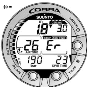
Abb. 3.19. Dekompressionstauchgang oberhalb der Dekompressionsstufe. Beachten Sie den abwärts gerichteten Pfeil und die "Er"- Warnung. Ausserdem hören Sie einen akustischen Alarm. Sie sollten sofort (innerhalb von 3 Minuten) mindestens auf die vorgeschriebene Deko-Stufe abtauchen.
