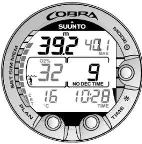
Abb. 3.25. Alternative Anzeige. Nach Drücken des TIME-Kontaktes wird die aktuelle Uhrzeit, die maximal erreichte Tiefe, die Temperatur, verbrauchte Nullzeit (CBT) und der Sauerstoffanteil O<sub>2</sub>% angezeigt (falls die Restluftzeit weniger als 30 Minuten beträgt).
