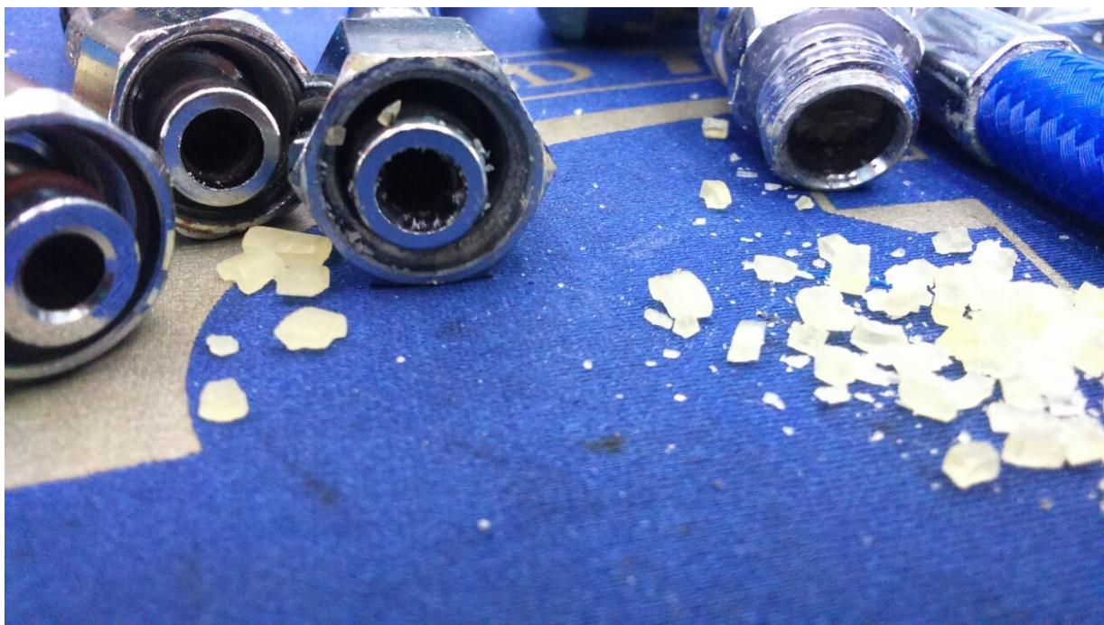
Es ist schwer vorherzusagen, wie lange der Zerfall einer Innenbeschichtung aus Polyester-TPU dauert, aber die uns vorliegenden Informationen lassen vermuten, dass dies bei freiliegenden Schläuchen bei 30°C und hoher Luftfeuchtigkeit in relativ kurzer Zeit der Fall sein kann.
