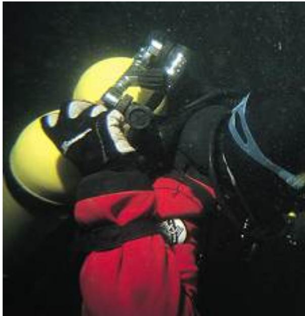
**Ventil der defekten Seite (mit der Leckage) bis an den Anschlag schliessen.**
