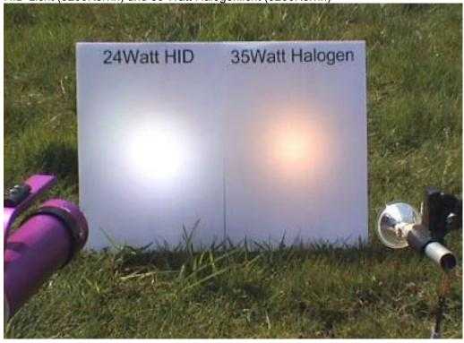
Typische Werte: Glühlampen: 2800 K Halogenlampen: 3200 K
