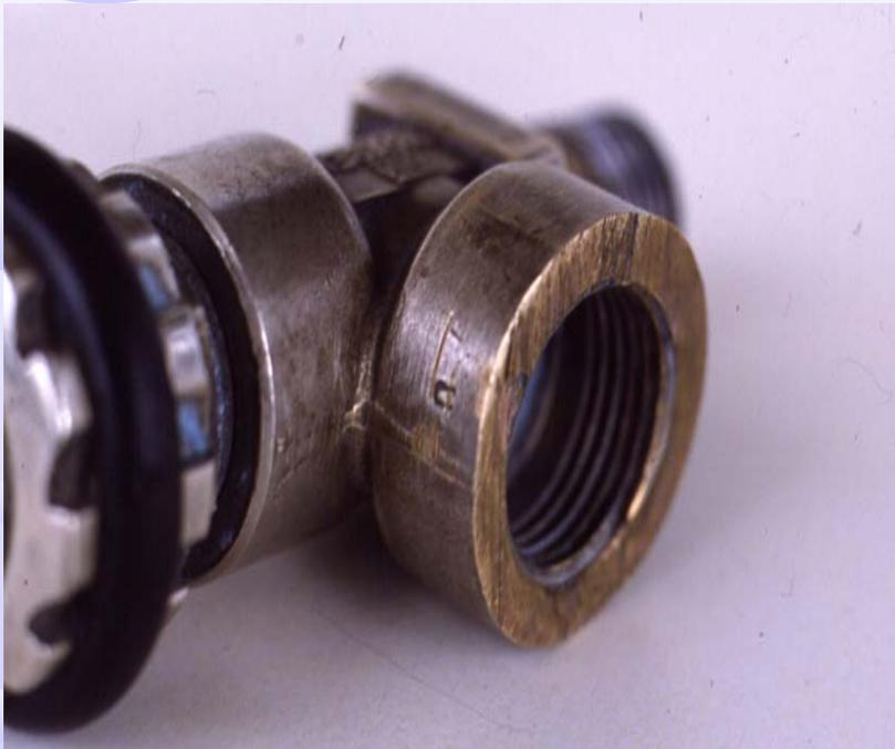
**200 bar-Flasche darf nicht am 300 bar Kompressor füllbar sein.**
