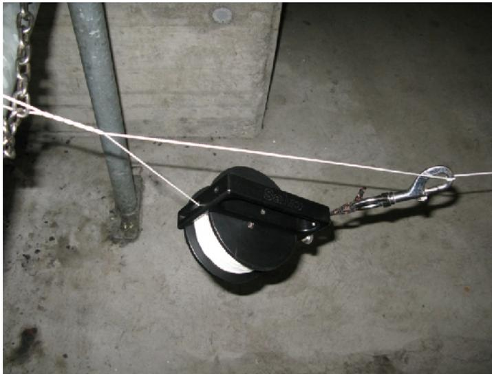
Endzustand: Reel hängt gesichert an Jump-Line, ca. 20-30cm von Main-Line entfernt
