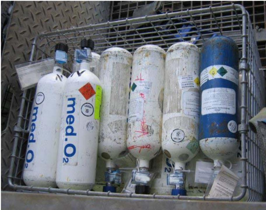
Bei diesem Transport ist ein ausreichender Ventilschutz nicht gegeben. Die Ventile können beim Transport gegen die Wände des Korbes schlagen. Dabei kann sich das Handrad lösen. Ein Gasaustritt ist möglich. Durch Füllen der Lücken ist ein Ventilschutz möglich.
