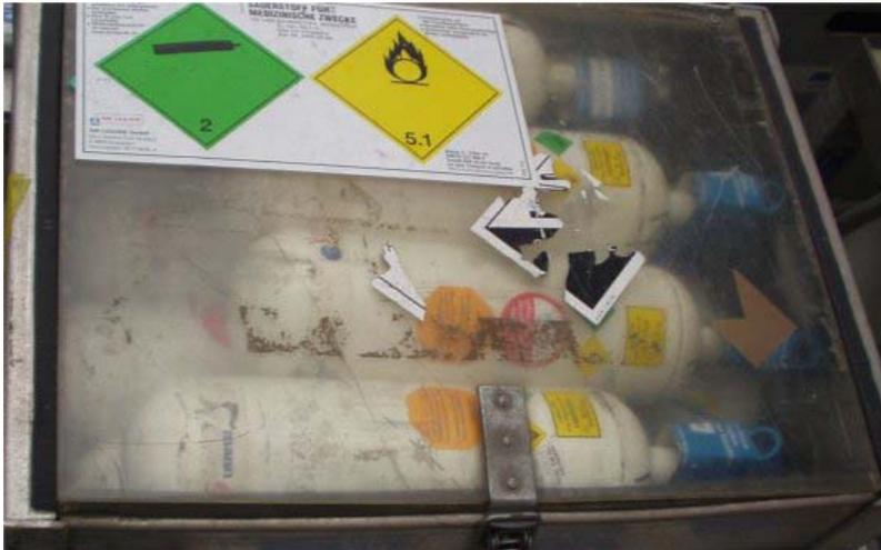
Flaschen werden in einer Kiste mit teiltransparentem Deckel transportiert. Die Kiste (=Umverpackung) ist ab 01.01.2005 mit dem Wort "Umverpackung" zu kennzeichnen. Bei wechselnden Gasarten sind die unzutreffenden Gefahrzettel von der Kiste zu entfernen. Flaschen und Ventile sind durch geeignetes Staumaterial gegen Verschieben beim Transport und Öffnen des Ventilhandrades zu schützen.
