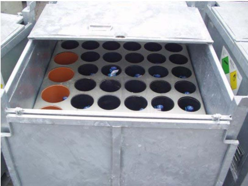
Dieser Metallkasten mit Deckel hat Röhren zum Flaschentransport. Da bei geschlossenem Deckel die Flaschen nicht sichtbar sind, ist die Umverpackung mit UN-Nummer(n) und Gefahrzettel(n) (Größe 10x10 cm) zu kennzeichnen. Des Weiteren ist der Metallkasten ab 01.01.2005 mit „Umverpackung“ zu kennzeichnen.
