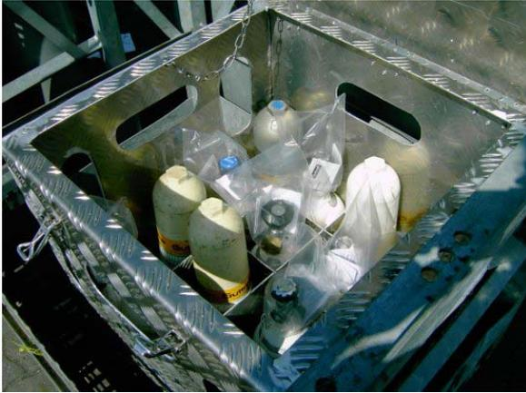
Die Metallkiste gibt einen ausreichenden Ventilschutz. Sie ist als Umverpackung einzustufen und muss ab 01.01.2005 mit der Bezeichnung „Umverpackung“ gekennzeichnet werden.
