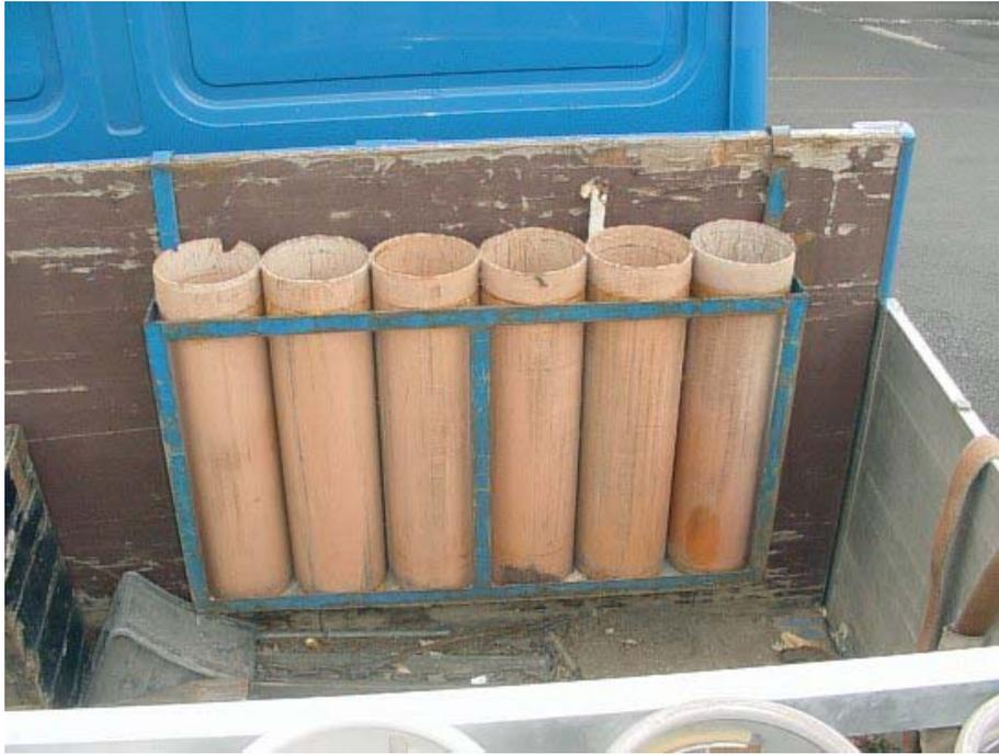
Haltung mit Röhren zum Transport von Kleinstahlflaschen. Die so angeordneten Röhren bieten einen Ventilschutz und dienen zusammen mit der Halterung der Ladungssicherung.
