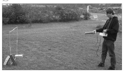
Die Positionierstation bei einem Test im Freien. Das Sendersignal kann bis zu 200 m durch den Felsen empfangen werden.
