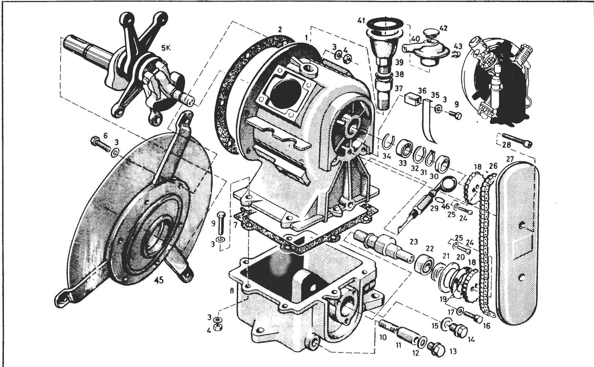
Triebwerk, Kolben, Zylinder
