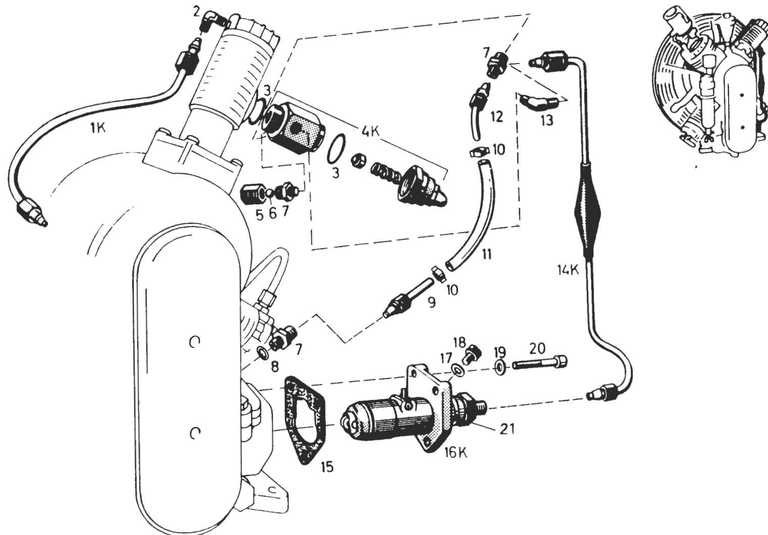
Zwischenfilter mit Sicherheitsventil
